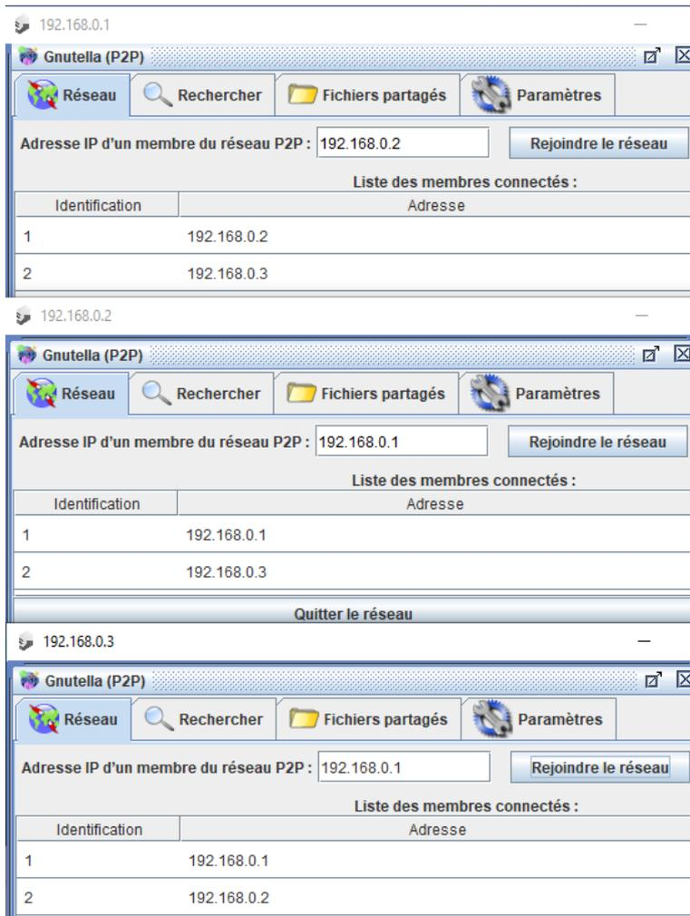
En principe , sur la machine 192.168.0.1 , dans fichier partagé se trouve le document `essai.doc`. Aller sur le bureau de la machine 192.168.0.2 et vérifier que dans le fichier partagé est vide. Pui cliquer sur rechercher taper `essai.doc` puis rechercher et enfin télécharger.
