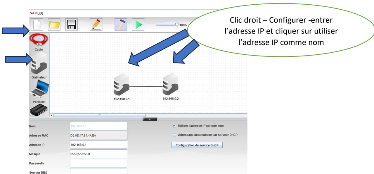
Passer en mode SIMULATION (▶) puis faire un clic gauche sur l'ordinateur **192.168.0.1** puis aller dans Installation et Ligne de Commande et appliquer les modifications
